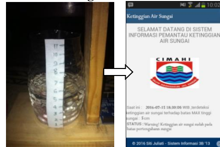
Gambar 4.13 Status Warning Gambar 4.13 menggambarkan bahwa ketinggian air sungai mencapai 5 cm yang menjelaskan status ketinggian air sungai ialah waring .
