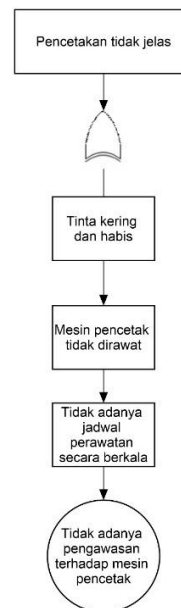
Gambar 6. Failure Tree Analysis (FTA) Pencetakan Tidak Jelas.
