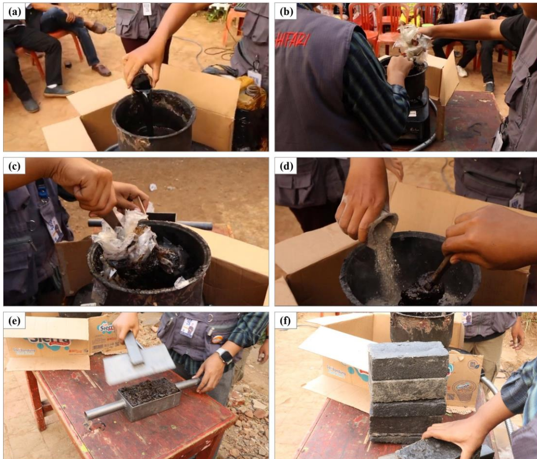
Gambar 2. Tahapan pembuatan paving block dari sampah plastik: (a) pemanasan oli bekas; (b) pelelehan sampah plastik ke dalam oli panas; (c) pengadukan hingga lelehan homogen; (d) pencampuran pasir ke dalam adonan; (e) pencetakan dan pemadatan; (f) sampel paving block hasil produksi
